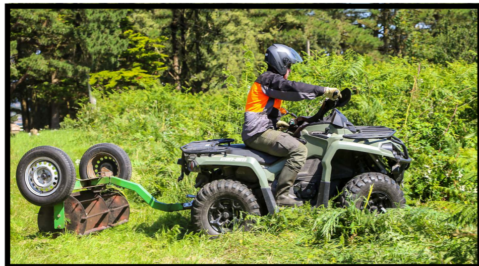
Le brise fougères est un matériel anglais qui empêche la profusion de fougères sans détruire toutes les plantes, à condition de tenir compte de la météo avant utilisation.
